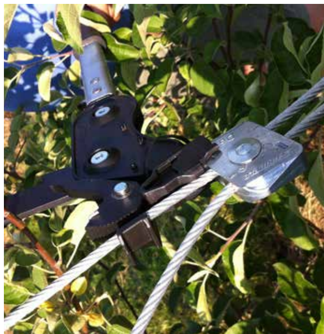
Dynamic 6 - Tensionamento con Contractor Tool
